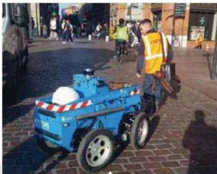
Sidene accompagne les techniciens d'Enedis en portant leur matériel, évitant l'utilisation d'un véhicule (ici en test à Toulouse).
