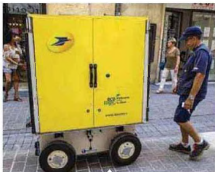
Hector, chariot automatisé, transporte courrier et petits colis. Il suit le facteur grâce à son système de capteurs (ici à Montpellier).
